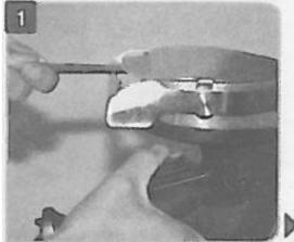
Schärfen Sie das Messer in einem Möglichst flachen Winkel von der Unterseite 1-2 Sekunden lang
