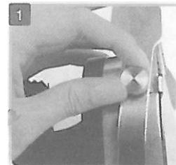
Entfernen Sie die Schraube und Sicherungsring.
